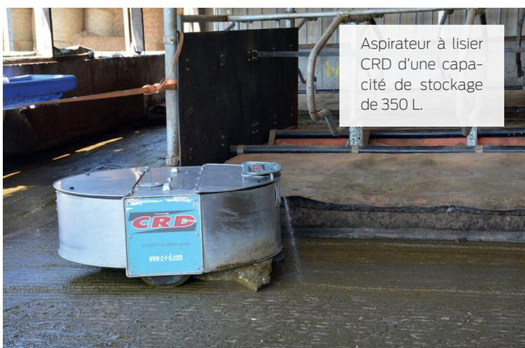
Aspirateur à lisier CRD d'une capacité de stockage de 350 L.
