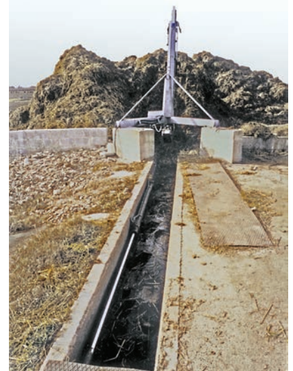
Un vérin hydraulique entraîne le va-et-vient sur lequel les palettes sont fixées.
