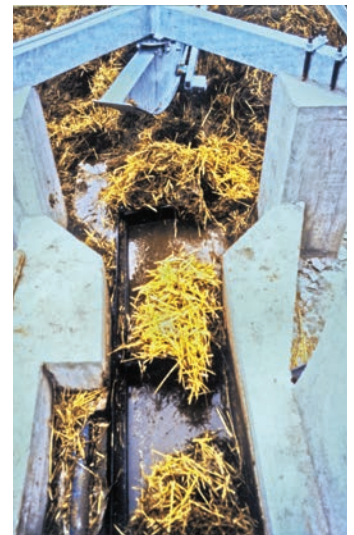
Les palettes soudées sont animées par un vérin hydraulique. Ce vérin peut être encastré ou monté sur support mural.
