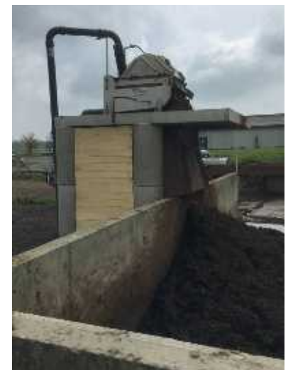
LE SÉPARATEUR DE PHASE À TAMIS RETRAITE LE DIGESTAT. LA PARTIE LIQUIDE EST ÉPANDUE SUR LES PARCELLES LES PLUS PROCHES. CETTE PRATIQUE A PERMIS D'ÉCONOMISER L'ACHAT D'ENGRAIS POUR PLUS DE 25 HA DE SURFACE AGRICOLE UTILE.
