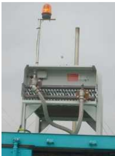
LE SÉPARATEUR DE PHASE À TAMIS RETRAITE LE DIGESTAT. LA PARTIE LIQUIDE EST ÉPANDUE SUR LES PARCELLES LES PLUS PROCHES. CETTE PRATIQUE A PERMIS D'ÉCONOMISER L'ACHAT D'ENGRAIS POUR PLUS DE 25 HA DE SURFACE AGRICOLE UTILE.
